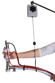
balanceersysteem voor handpistolen
